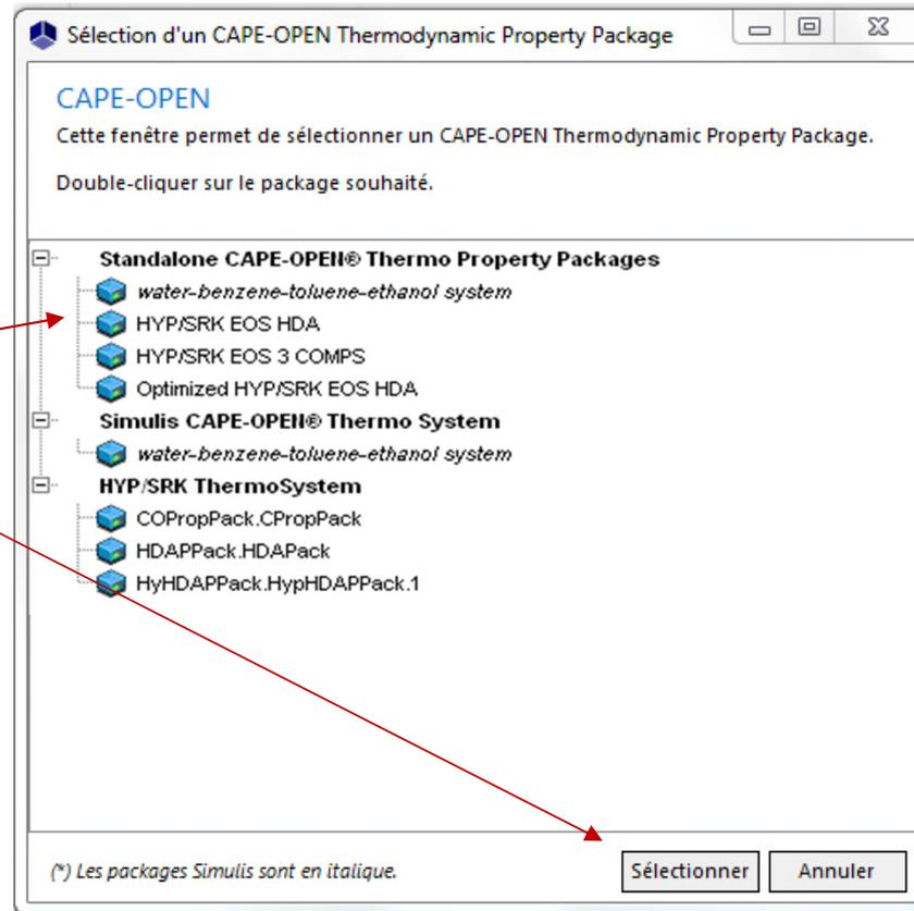
Les packages thermodynamiques créés avec Simulis Thermodynamics sont automatiquement compatibles CAPE-OPEN. Ils sont présentés en italique.
