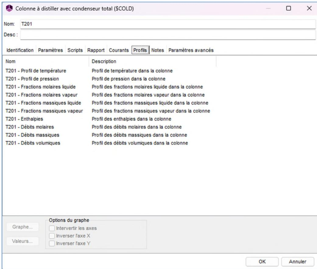
Remarque : dans ProSimPlus, les étages des colonnes sont numérotés de haut en bas (le premier plateau correspond au condenseur, le dernier au rebouilleur).
