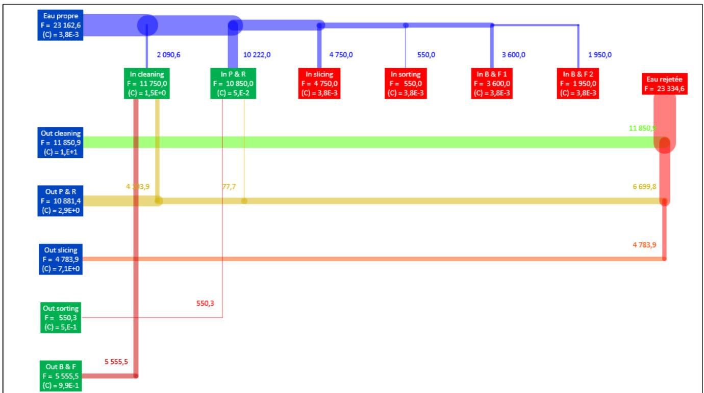
Le réseau propose de réutiliser les courants de sortie de blanchiment et de tri optique afin de remplacer partiellement les entrées des opérations de lavage et pelage. De plus, les rejets d'eau de l'étape de pelage/rinçage pourraient être
