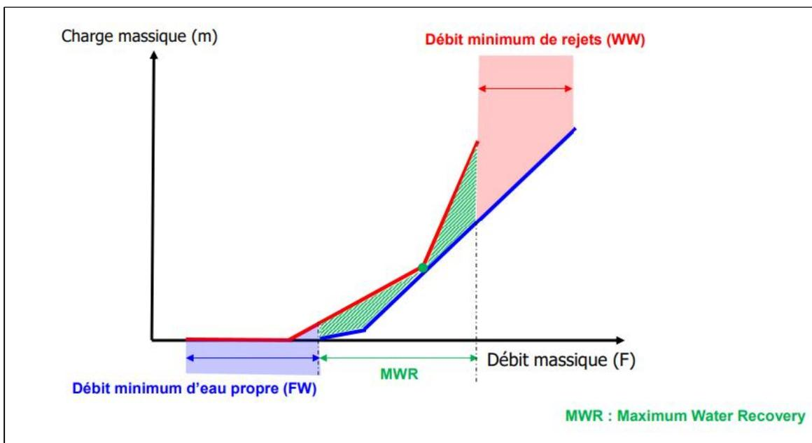
L'analyse Pinch permet donc d'établir les cibles de consommations et de rejets minimales d'eau nécessaire pour satisfaire les besoins d'un procédé, et ce, avant même de commencer la conception du réseau de réutilisation d'eau. Cela permet d'identifier rapidement l'ampleur des économies d'eau qui peuvent être envisagées à un stade préliminaire de l'analyse. Cet avantage est probablement le plus intéressant qu'offre l'analyse Pinch.
