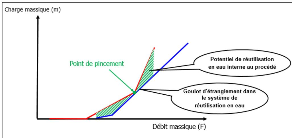
Les 2 courbes sont translattées horizontalement jusqu'à ce qu'elles se touchent. La courbe composée puits doit être au-dessus de la courbe composée source. Le point de contact entre les deux courbes est appelé « point de pincement ».
