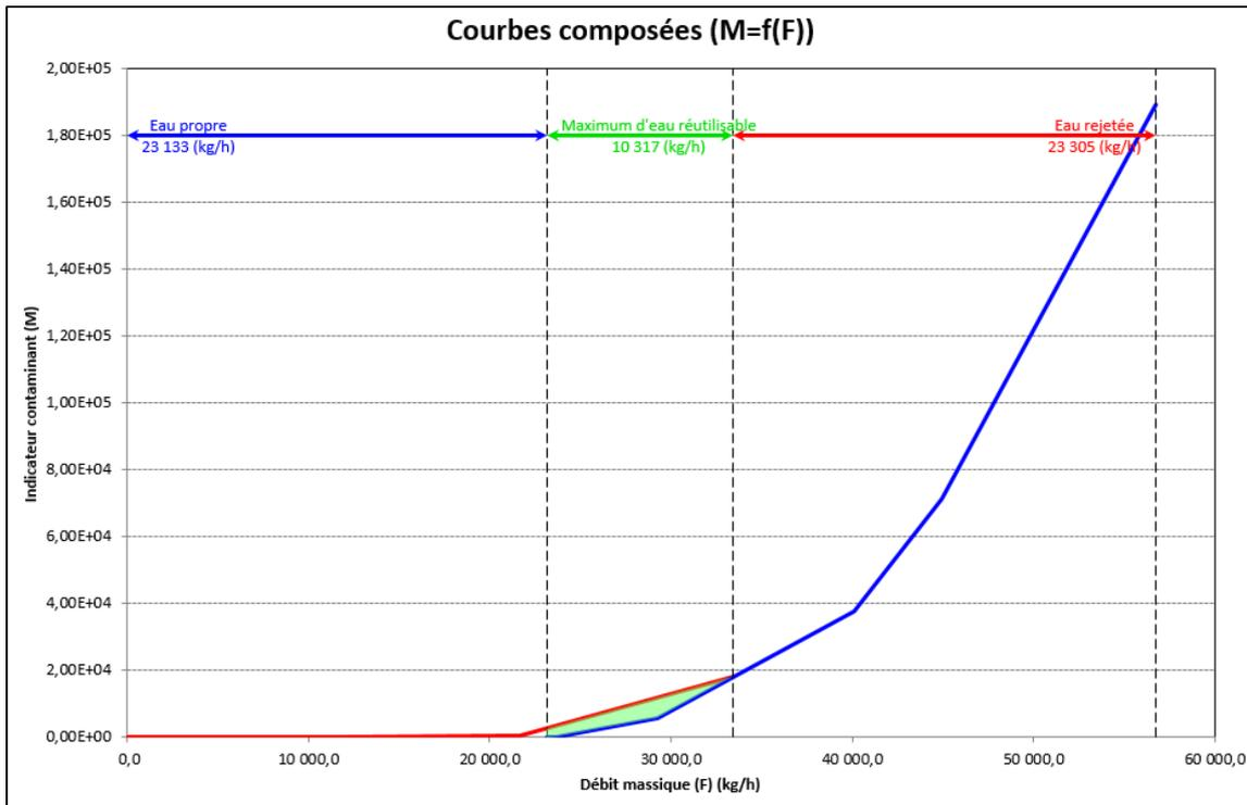
Le tracé des courbes composées est un des résultats principal de l'analyse de pincement eau. Pour cet exemple, il est possible de constater l'existence d'un potentiel de réutilisation (MWR) d'environ 10.3 t/h.
